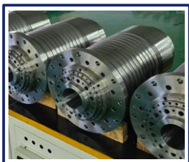
Шпиндели (сборка на ООО «Ульяновский станкостроительный завод»)
